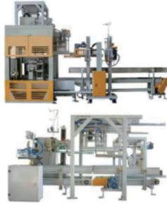
自动上袋机组 Automatic Bag-loading System
