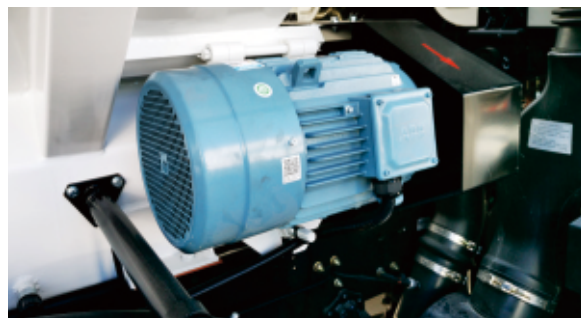
电动绞龙散装饲料车水平绞龙电机（品牌电机）
