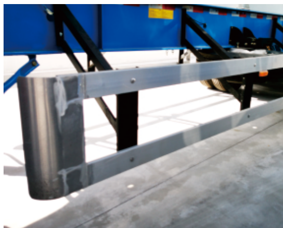
散装饲料运输半挂车侧防护（铝合金材质）
