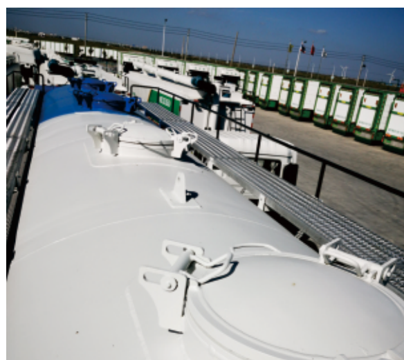
气卸车罐顶进料口
