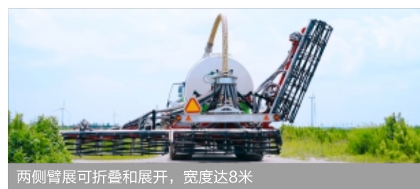
整车由牵引车、罐体、施肥器三部分组成
